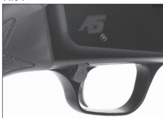
Предохранитель в безопасном положении
