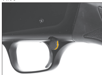
Предохранитель в положении для стрельбы
