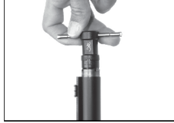
Şok tüpünü namluya monte etmek için şok tüpü T anahtarını kullanın.
