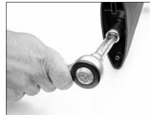
Utilice una llave de tubo para extraer la tuerca de la culata.
