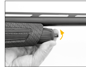
Убедитесь в том, что цевье правильно зафиксировано с помощью фиксатора.
