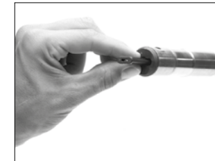
Rimozione del riduttore a tre colpi.
