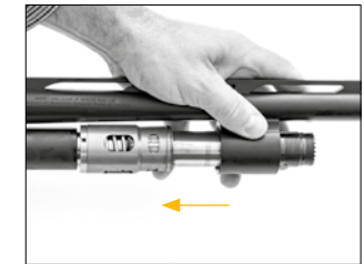
Задвиньте ствол и поршень на трубчатый магазин и хвостовик ствола в ствольную коробку
