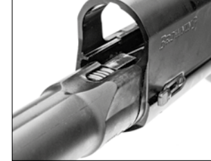
Alinee la baqueta de empuje con la ranura del cajón de mecanismos.
