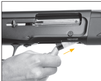
Stoppa in en patron i uttaget under lådan och tryck den så långt fram det går.
