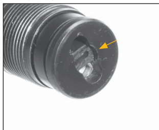
L'adattatore a tre colpi (riduttore) posizionato nel tubo del serbatoio
